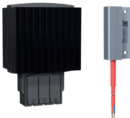
Нагреватели MEYERTEC MTK-EH и MTK-SH10 применяются совместно с термостатами в шкафах управления и автоматики для предотвращения образования конденсата и коррозии, поддерживая заданную положительную температуру воздуха.
